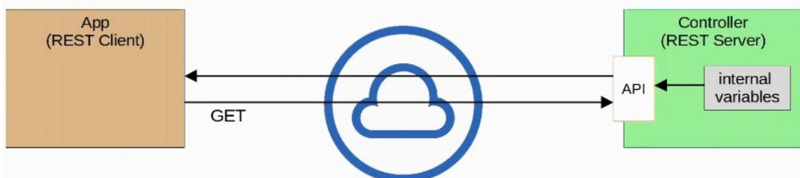
Ci dessous l'application envoie une requête GET vers le controller, le controller réceptionne la demande par l'API et répond à sa requête.
